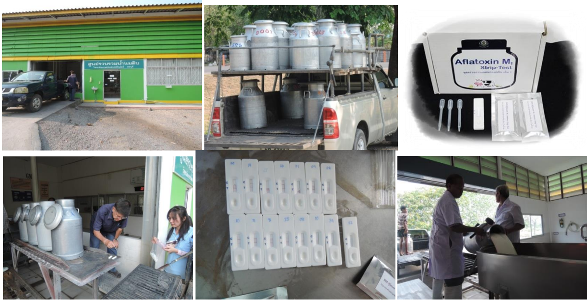
ภาพที่ 3 การนำชุดตรวจสอบ AFM 1 Lateral flow Strip Test ไปทดสอบตรวจสอบสาร AFM 1 ในน้ำนมดิบ ที่จุดรวบรวมน้ำนมดิบจากเกษตรกร อ. พนัสนิคม จ. ลพบุรี
